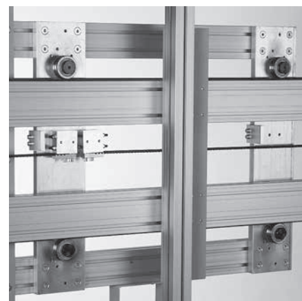
Schlittenplatten nach Kundenzeichnung
